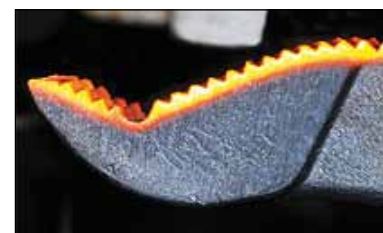
Induktivno okaljene čeljusti
